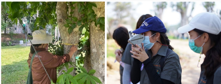
รูปที่ 27 การวัดเส้นรอบวงของต้นไม้ที่ระดับ 1.30 เมตร จากพื้นดิน (ซ้าย) และการวัดความสูงด้วยเครื่องมือ Haga Altimeter (ขวา)
